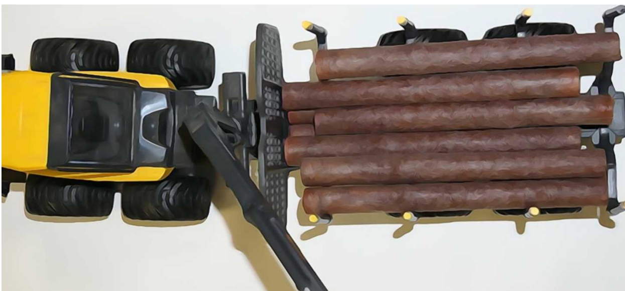
Рис. 6 Расположение сортиментов в грузовом отсеке с нарушением
