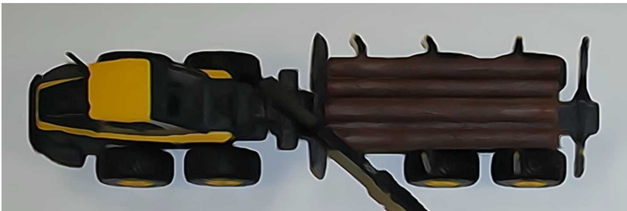
Рис. 4 Расположение сортиментов в грузовом отсеке
