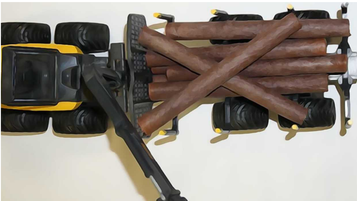
Рис. 5 Расположение сортиментов в грузовом отсеке с перекрещиванием
